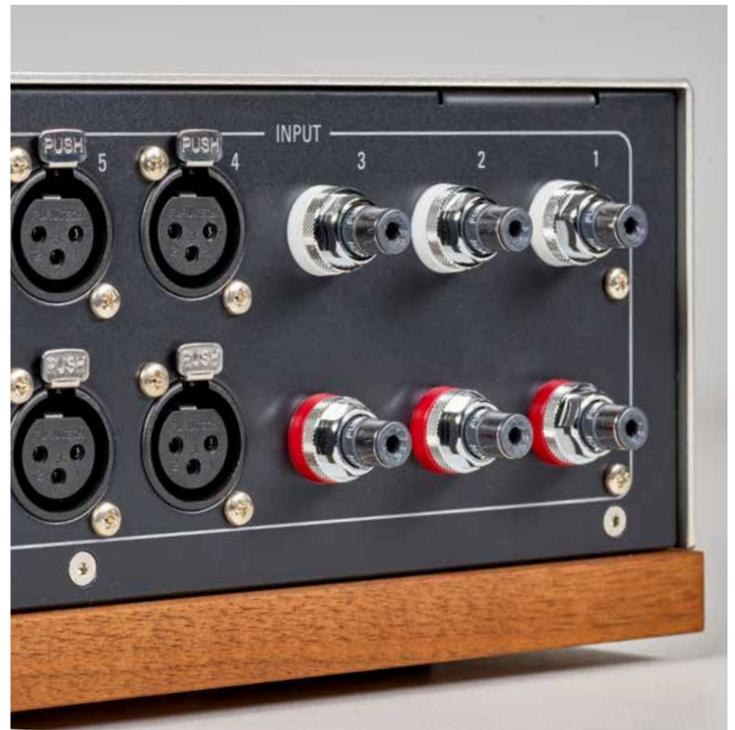
Dem Funktionsprinzip entsprechend sucht man aktive Bauteile wie Transistoren oder Röhren ebenso vergeblich wie einen Stromanschluss. Gleichwohl erlaubt die Schaltung per Drehregler eine Spannungsanhebung um 6 dB. Rechts: XLR-Buchsen von Neutrik und rhodinierte Furutech-Cinchanschlüsse machen den Qualitätsanspruch des CM-2200 deutlich.
