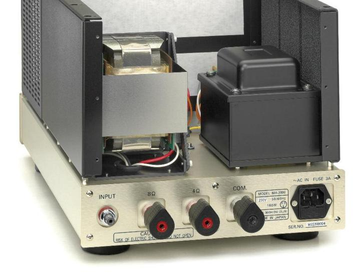
Ausgangsübertrager und Netztrafo dominieren alleine von ihrer Größe her das "Eisenensemble" der MA-2000-Monos. Selbstverständlich sind sie für Phasemation spezifiziert und hergestellt. Auffällig sind auch die massiven Lautsprecheranschlüsse, die jedwedem Lautsprecherkabel einen perfekten Sitz ermöglichen. Das macht richtig Freude
